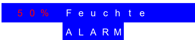
Abb. 21 - Displaytexte bei Feuchtealarm. Hier rot dargestellte Zeichen blinken, die Worte "Feuchte" und "ALARM" erscheinen abwechselnd.
