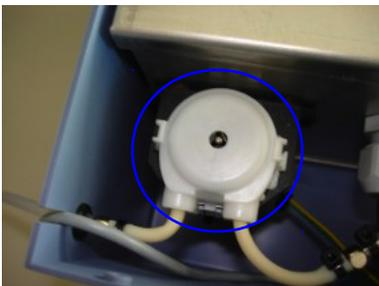
Abb. 26 - Pumpenkopf (hier im Gehäuse eines EBC10/11)
