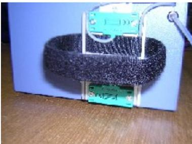
Abb. 3 - Wasserstandensensoren für die Alarmauslösung bei Über-/Unterschreitung der oberen bzw. unteren Marke in der Flasche. Im Symbolfoto sind die Halter zur Seite eines EBC10 od. -11 montiert. Sie können ebenso an der Gerätefront angebracht werden. Bei einem EBC12 sind sie immer zur Front montiert; eine seitliche Montage kann hier nur mit zusätzlich zu bestellendem Zubehör erfolgen.
