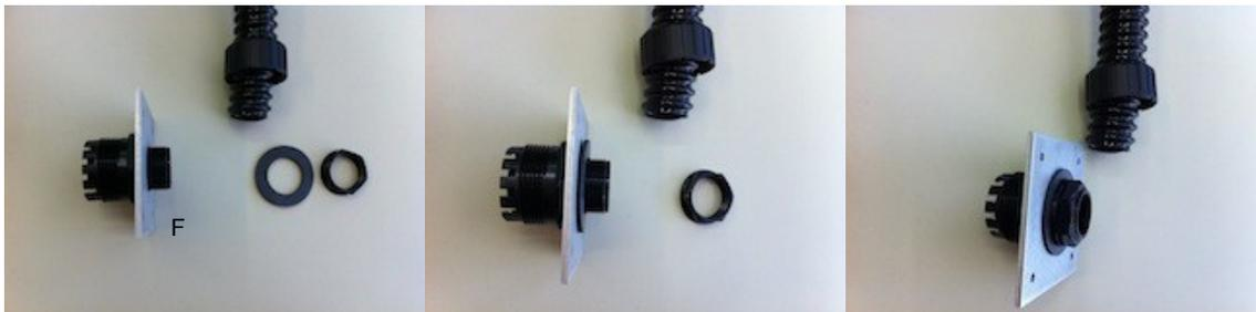
3) Drücken Sie schließlich den Schlauch bis zum Anschlag in den Adapter und fixieren Sie die Verbindung mit der Gegenmutter. **WICHTIG:** Alle Lamellen des Adapters müssen sich außerhalb des Schlauches befinden und dürfen nicht geknickt werden:
