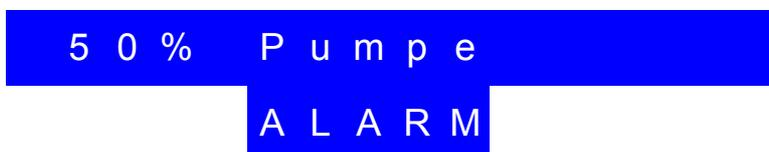
Abb. 25 - Displaytexte bei Pumpenalarm. Die Worte "Pumpe" und "ALARM" erscheinen abwechselnd.
