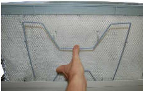
Abb. 28: Filterbügel entfernen
