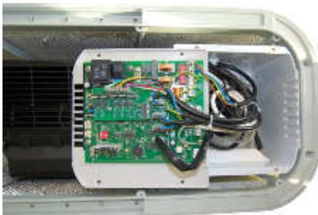
Abb. 20: Bedientableau abheben
