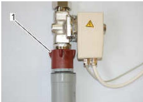
*Abb. 81: Sicherheitsdruckschlauch am Wasserwächter lösen*
