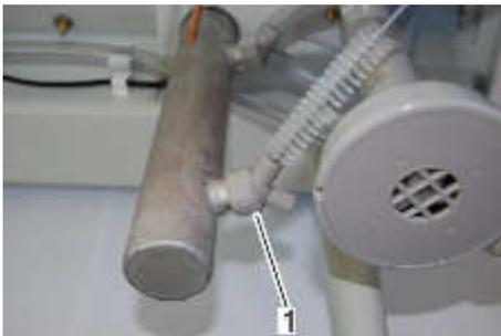
Abb. 68: Edelstahlrohr reinigen
