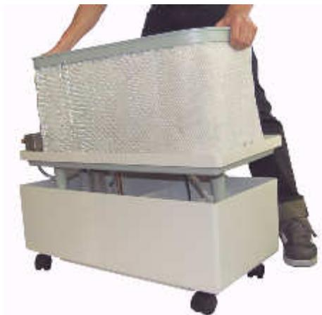
Abb. 65: Mittelteil entfernen
