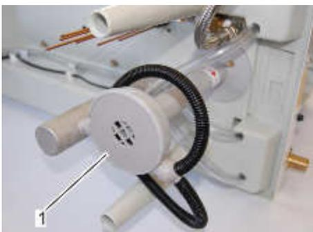
Abb. 40: Pumpenkörper reinigen
