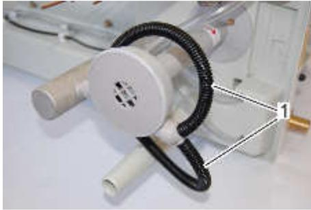
Abb. 50: Pumpenschläuche anbringen
