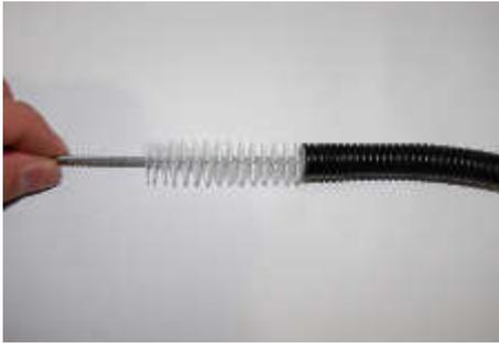
Abb. 67: Pumpenschläuche reinigen
