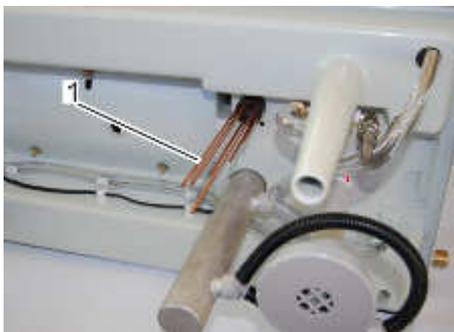
Abb. 26: Elektrodenstäbe reinigen
