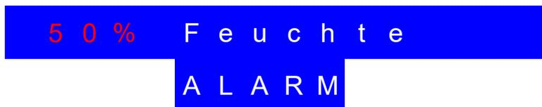
Abb. 24 - Displaytexte bei Feuchtealarm. Hier rot dargestellte Zeichen blinken, die Worte "Feuchte" und "ALARM" erscheinen abwechselnd.
