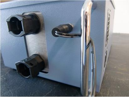
Das Kabel des 12V-Netzteils sollte zur Zugentlastung zwischen dem Griff und dem Gehäuse des EBCeasy verlegt werden.
