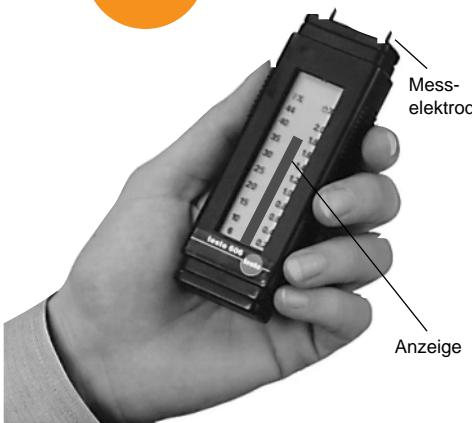
**testo 606** dient zur Messung des Feuchtegehalts in Schnittholz (u. U. Pappe, Papier) und abgebundenen Baustoffen (Putz, Estrich). Es zeigt den Feuchtigkeitswert des Werkstoffes direkt an. Das Gerät besitzt eine mittlere Justierung für europäische Hölzer und bezieht diese auf eine Holztemperatur von 20°C.
