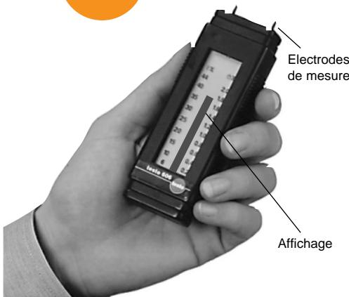
**testo 606** mesure le degré d'humidité de bois (carton-pâte, papier) et de matériaux de construction. Il indique instantanément la valeur d'humidité du matériau. L'appareil est équipé d'un ajustage pour les boisages européens et est calibré sur une température de bois de 20°C.
