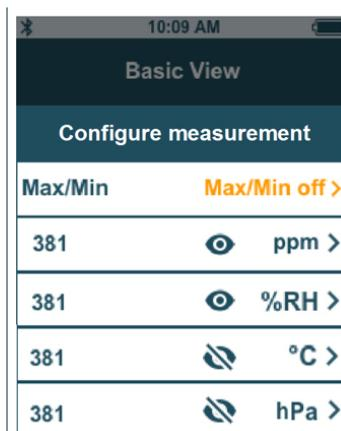
Werden einzelne Werte ausgeblendet, hat dies keinen Einfluss auf die Anwendung, nur auf die Standardansicht und die Langzeitmessung. Die eingestellten Einheiten werden hingegen auch in die Anwendungs-Menüs übernommen.
