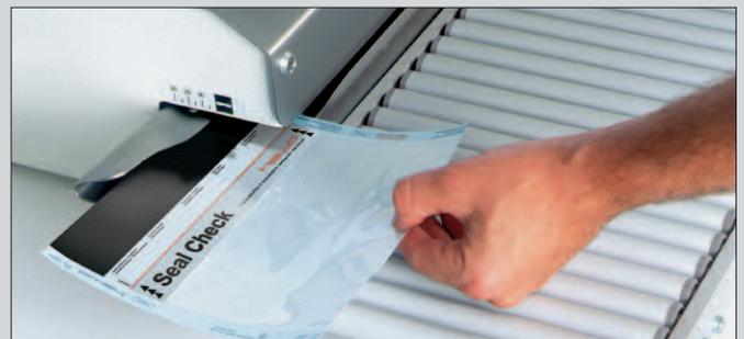
**Seal Check med:** Testsystem zur routinemäßigen Überprüfung und Funktionsbeurteilung (OQ) nach DIN EN ISO 11607-2:2006
