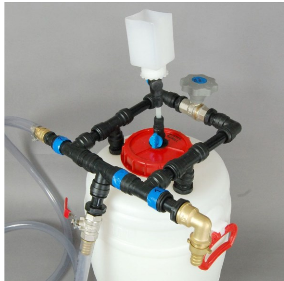
Befeuchtungseinrichtung zum Befeuchten des Gasstroms bei Stickstoffbegasungen
