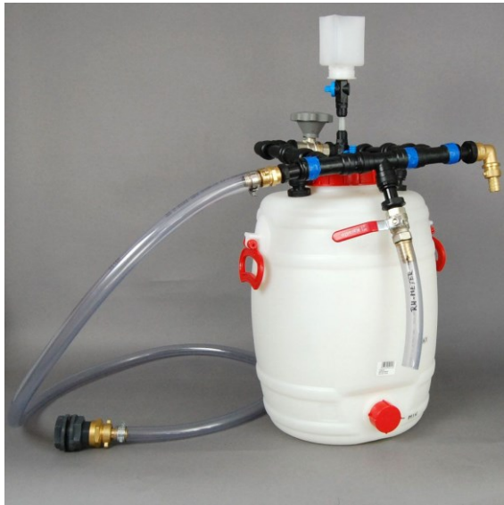
Befeuchtungseinrichtung zum Befeuchten des Gasstroms bei Stickstoffbegasungen
